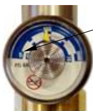
Рисунок 30 – Манометр на редукторе баллона
