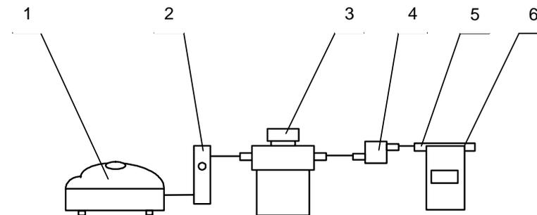
1 - компрессор; 2 - ротаметр; 3 – генератор ГС;
