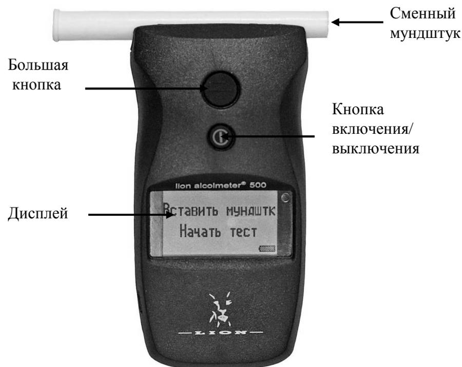
Рисунок 1. Анализатор Lion Alcolmeter 500.
