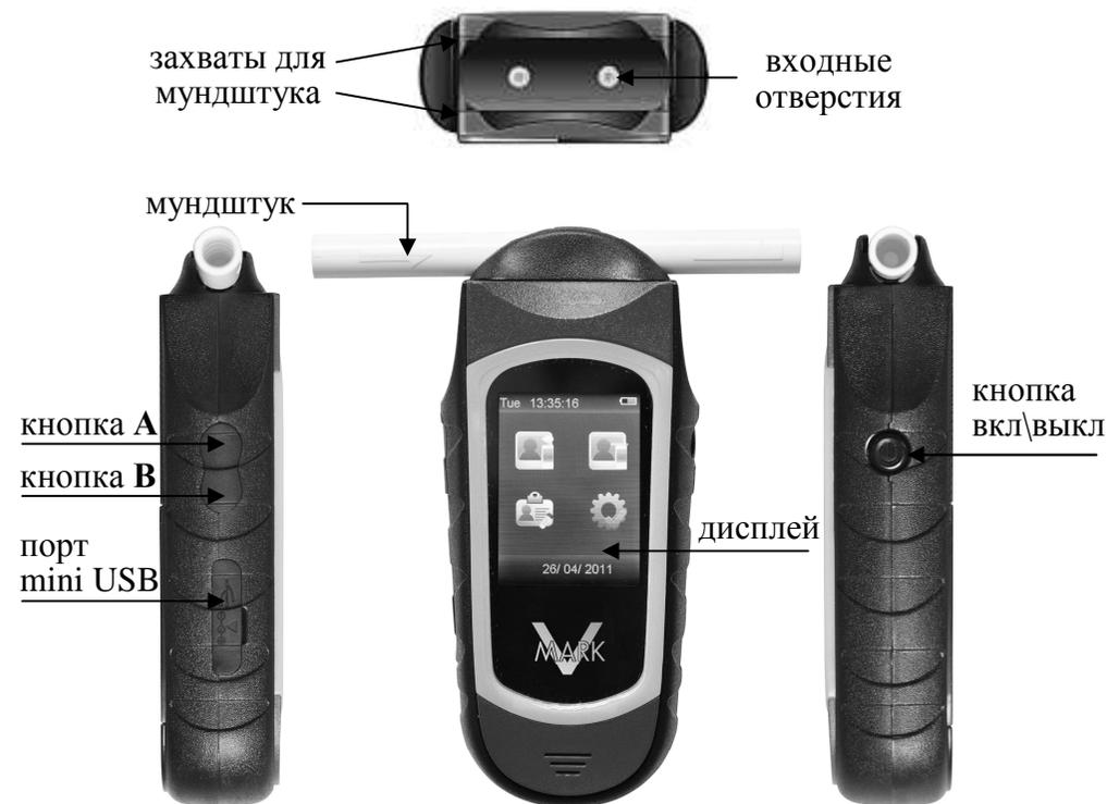
Рисунок 1 – Внешний вид анализатора
